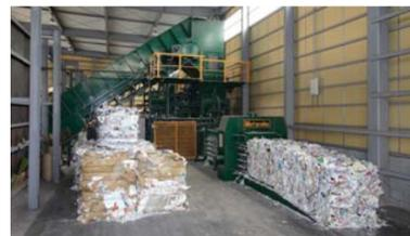
3 プレス機により運びやすい形に圧縮・加工されます。
